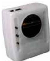
Aldabra dispone di un tipo di centralina che impiega il protocollo di comunicazione DMX 512 (Digital Multiplexed).
