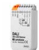
Questo dispositivo è compatibile con il protocollo DALI (Digital Adressable Lighting Interface). Questo convertitore è in grado di controllare i canali di dimmerazione per i dispositivi monocromatici, RGB e DWS. Le dimensioni sono ridotte e può essere alloggiato in una scatola E503 da incasso a muro.
